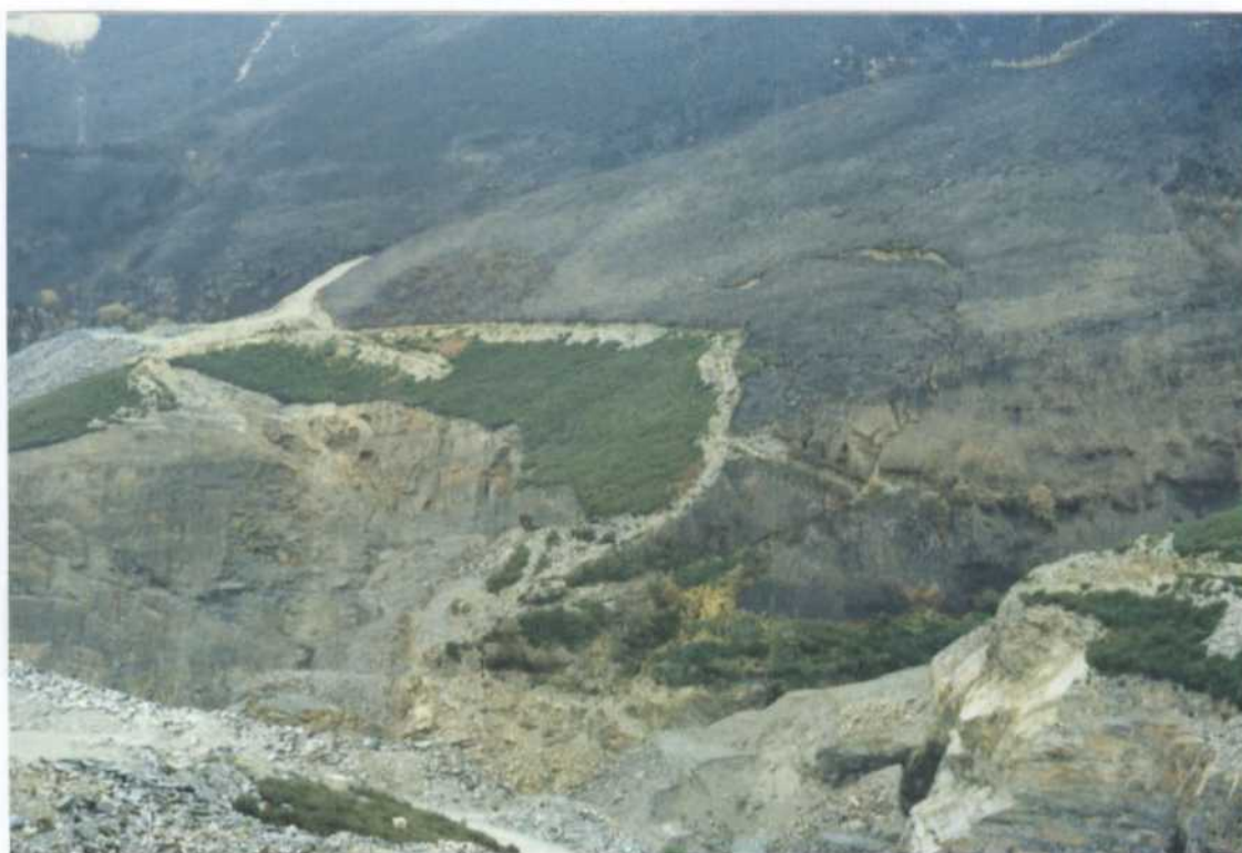
FOTO N° 8: Vista de frente de arranque en explotación de pizarras, con inestabilidades (hundimientos) en lo alto del inmediato avance, afectando al macizo rocoso.
