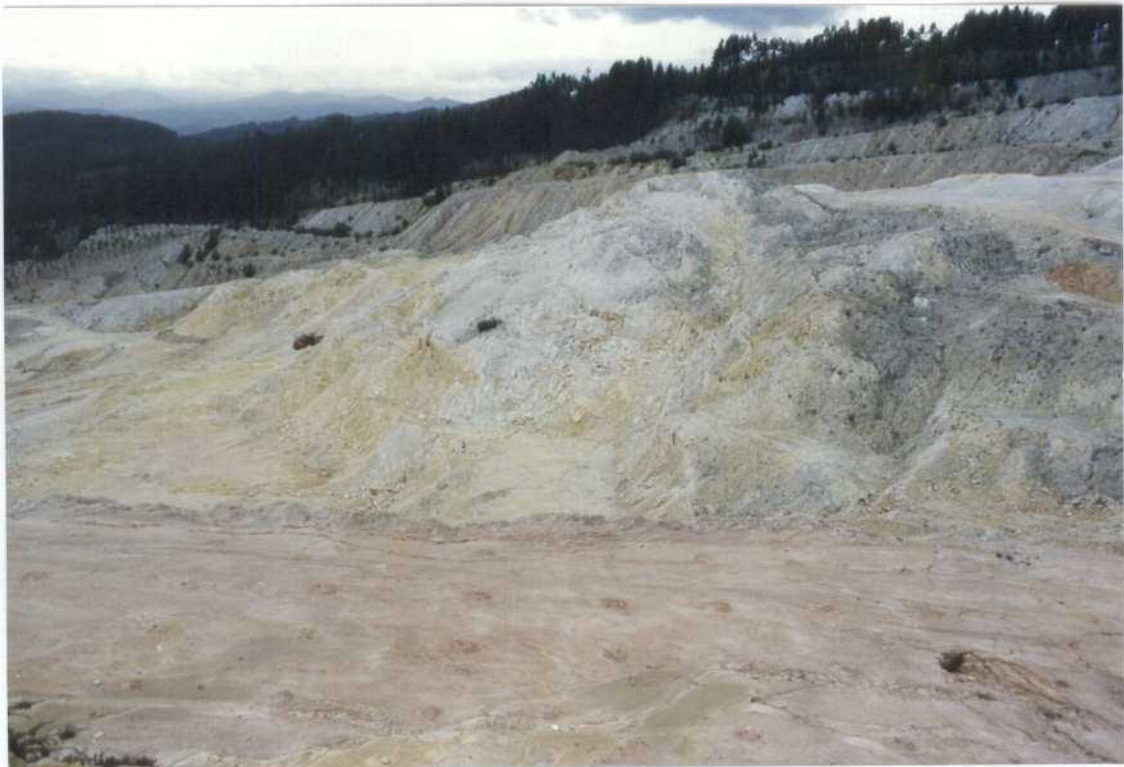
FOTO N° 19: Detalle de litología e inestabilidades en frente de arranque de caolín.
