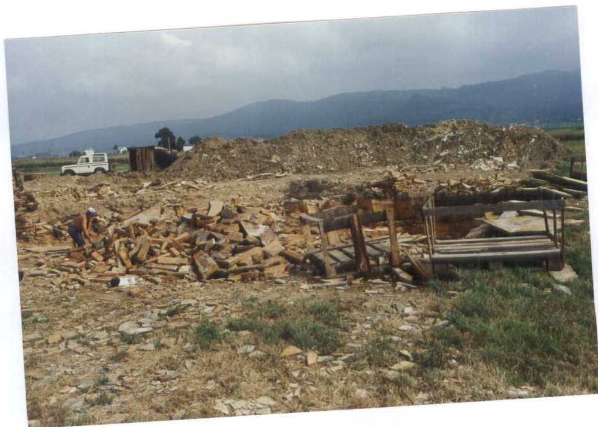
FOTO Nº 22: Pequeña explotación recién iniciada de cuarcitas ornamentales en la zona de Ribadeo.
